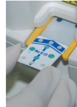
3. Plaats de E-plate zonder de contactpunten aan te raken.
