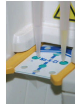
7. Let op dat de pipetpuntjes boven de groene gaatjes staan.
