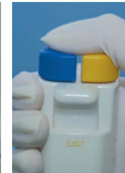
8. Pipetteer door beide knoppen geheel in te drukken.
