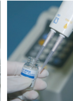
4. Plaats 2 schone pipettips op de dual pipet en zuig met de blauwe knop de referentievloestof op.
